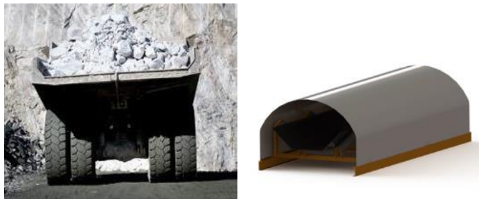
FIG. 12- Transporte de mineral bruto (Dumper) a la izquierda y pantalla de transportista cubierta (derecha)
