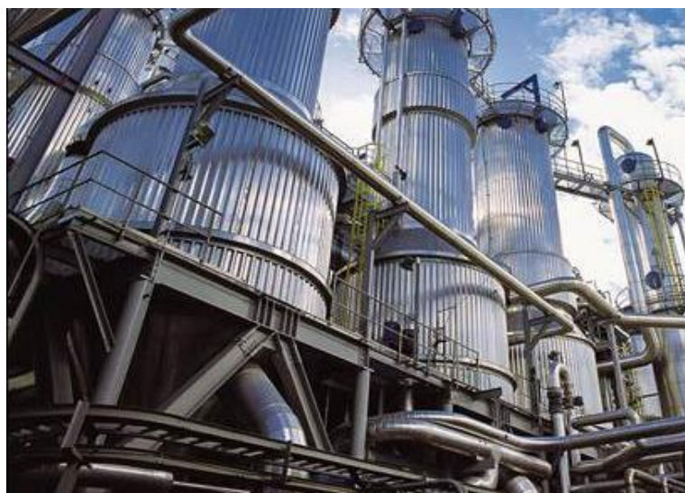
FIG.22- Cristalizadores de hidróxido de litio
